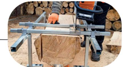
La tronçonneuse peut être montée verticalement afin de pouvoir couper l'écorce des deux côtés de la bûche avant d'effectuer plusieurs coupes horizontales.
