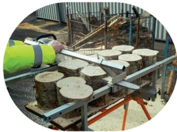
Les rails de guidage permettent à la tronçonneuse de se déplacer et d'effectuer des coupes parfaitement horizontales.
