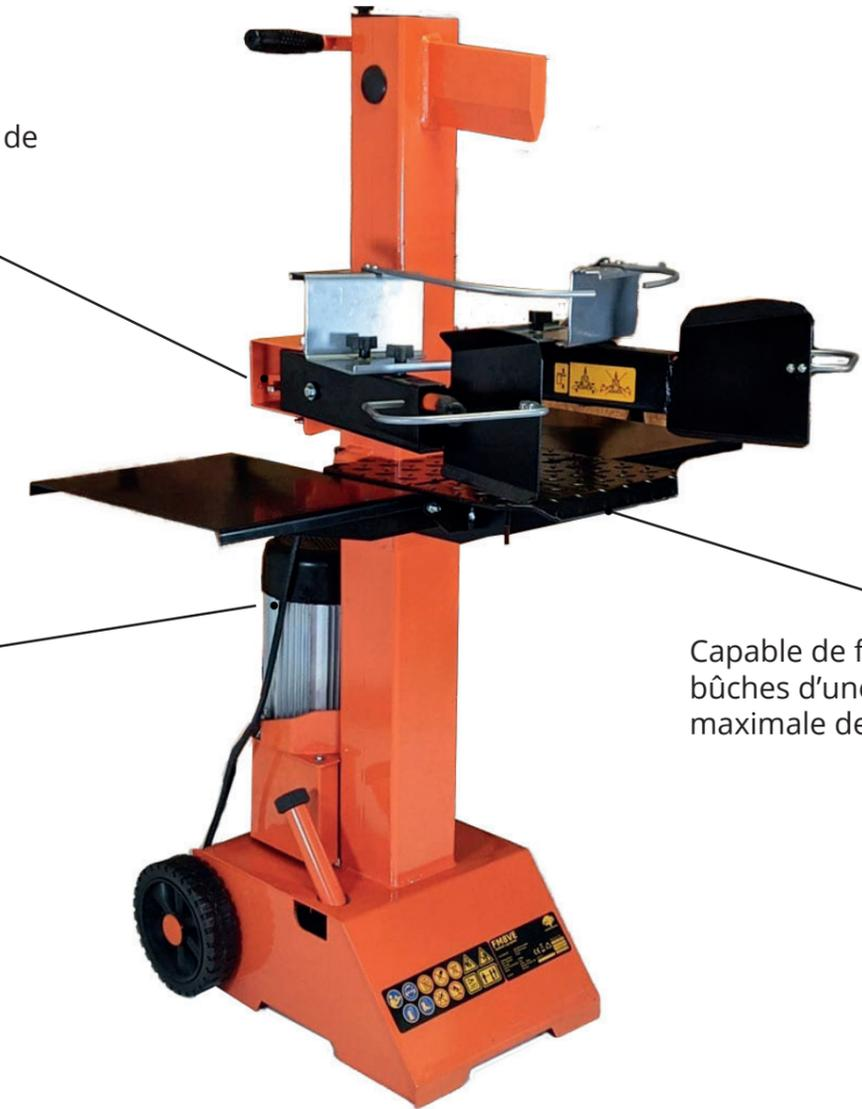
Équipé du plus gros moteur électrique pouvant être utilisé sur une prise à 3 broches, notre FM8VE est un fendeur de bûches vertical robuste capable de fendre des bûches d'une longueur maximale de 550 mm. Armé d'une puissance de fendage de 8 tonnes, ce fendeur de bûches vertical peut facilement fendre du bois dur non séché.
