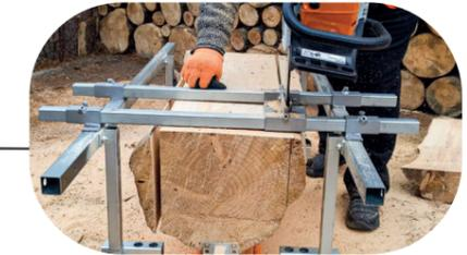
La motosierra puede montarse verticalmente para poder cortar la corteza de ambos lados del tronco antes de realizar múltiples cortes horizontales.
