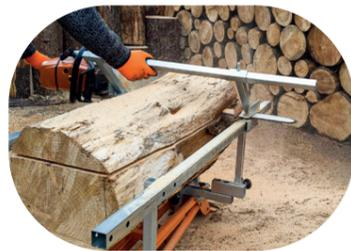
Las guías se pueden bajar rápidamente para realizar varios cortes sin ajustar la posición de la madera.
